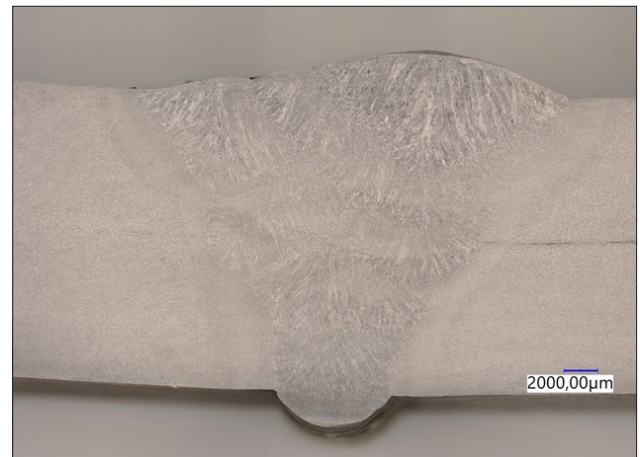
Rys. 3. Makrostruktura złącza (metoda „B”)
