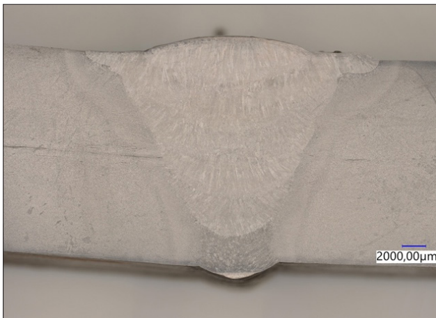
Rys. 2. Makrostruktura złącza (metoda „A”)
