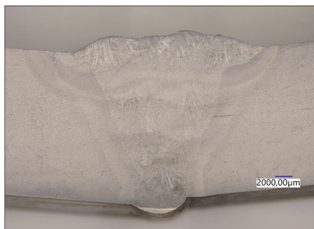
Rys. 4. Makrostruktura złącza (metoda „C”)
