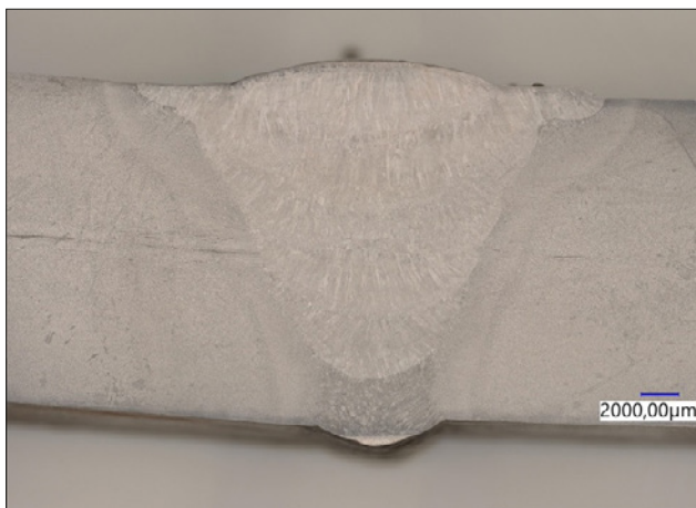
Rys. 2. Makrostruktura złącza (metoda „A”)
