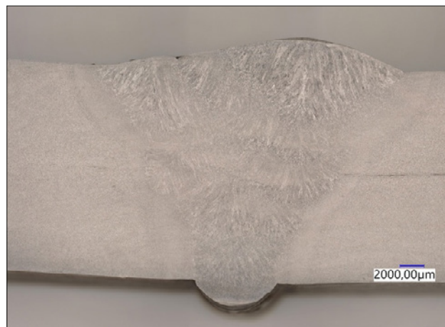
Rys. 3. Makrostruktura złącza (metoda „B”)
