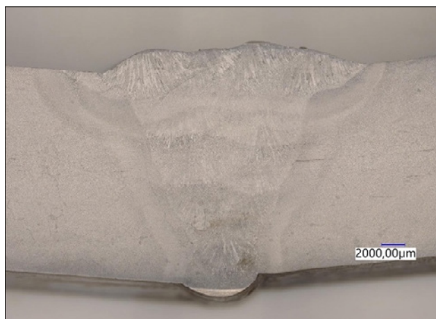
Rys. 4. Makrostruktura złącza (metoda „C”)
