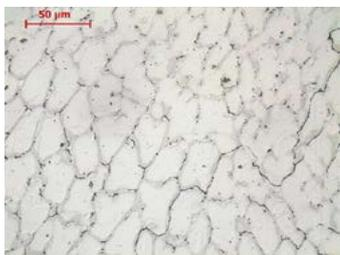
Fig. 3. Weld microstructure (Thermanit 304HCu wire)
