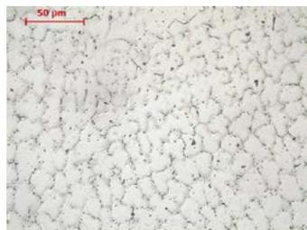
Fig. 4. Weld microstructure (EPRI P87 wire)
