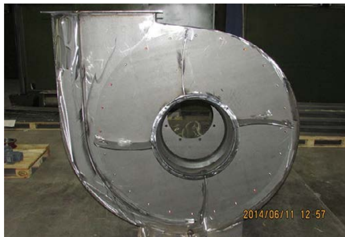
Fig. 3. Fan for overlay welding
