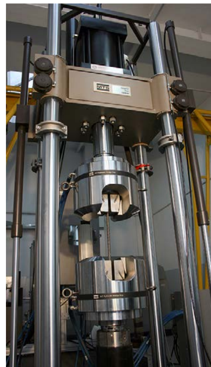
Fig. 5. Test rig at Instytut Spawalnictwa (MTS 810 testing machine)
